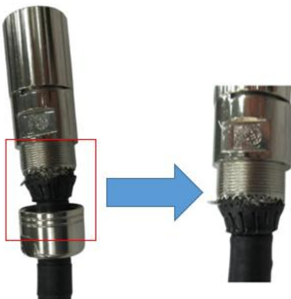
Obr.5 .17 : Stínění musí mít vodivé spojení s kruhovým konektorem
